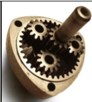
Dans le cas d'un engrenage composé d'une roue à denture interne et d'une roue à denture externe, les deux roues tournent dans le même sens.
