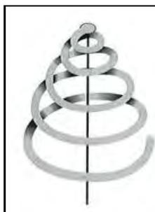
Placer une spirale en papier au-dessus d'une source de chaleur. La spirale va se mettre à tourner sous l'effet de l'air qui monte !
