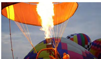
C'est ainsi que l'on a placé un brûleur à la base de l'enveloppe de la montgolfière, afin de chauffer l'air à l'intérieur de celle-ci, permettant à l'ensemble de décoller !
